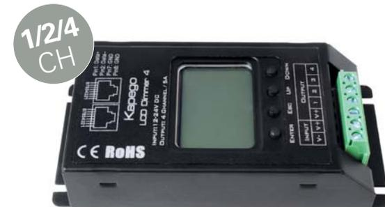
Verwendung als **1, 2 und 4 Kanal Dimmer**. Ein manueller Modus ermöglicht die 4 Kanäle am Gerät einzeln zu dimmen (Farbeinstellung). Inkl. Master/Slave Funktion, Masterdimmer und 13 Farbwechselprogrammen, die in der Geschwindigkeit verändert werden können. Alle Einstellungen sind über ein einfaches Menü via LCD Display abrufbar.
