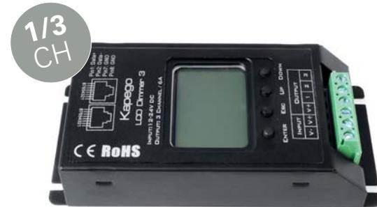
Verwendung als **1 oder 3 Kanal Dimmer** (Ansteuerung über eine DMX Adresse). Ein manueller Modus ermöglicht die 3 Kanäle am Gerät einzeln zu dimmen (Farbeinstellung). Inkl. 27 Farbwechselprogramme und Master/Slave Funktion. Alle Einstellungen sind über ein einfaches Menü via LCD Display abrufbar.
