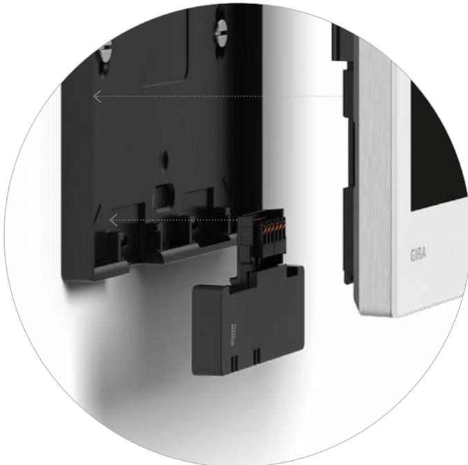
**Einfache Montage:** Das Gira G1 Temperaturfühlermodul ist schnell und leicht zu montieren. Zunächst den Gira G1 entriegeln und das Displaymodul herausnehmen. Anschließend den Blindstopfen an der Unterseite des Aufnahmerahmens entfernen und an seiner Position das Temperaturfühlermodul einstecken. Zum Schluss wird das Displaymodul wieder in den
