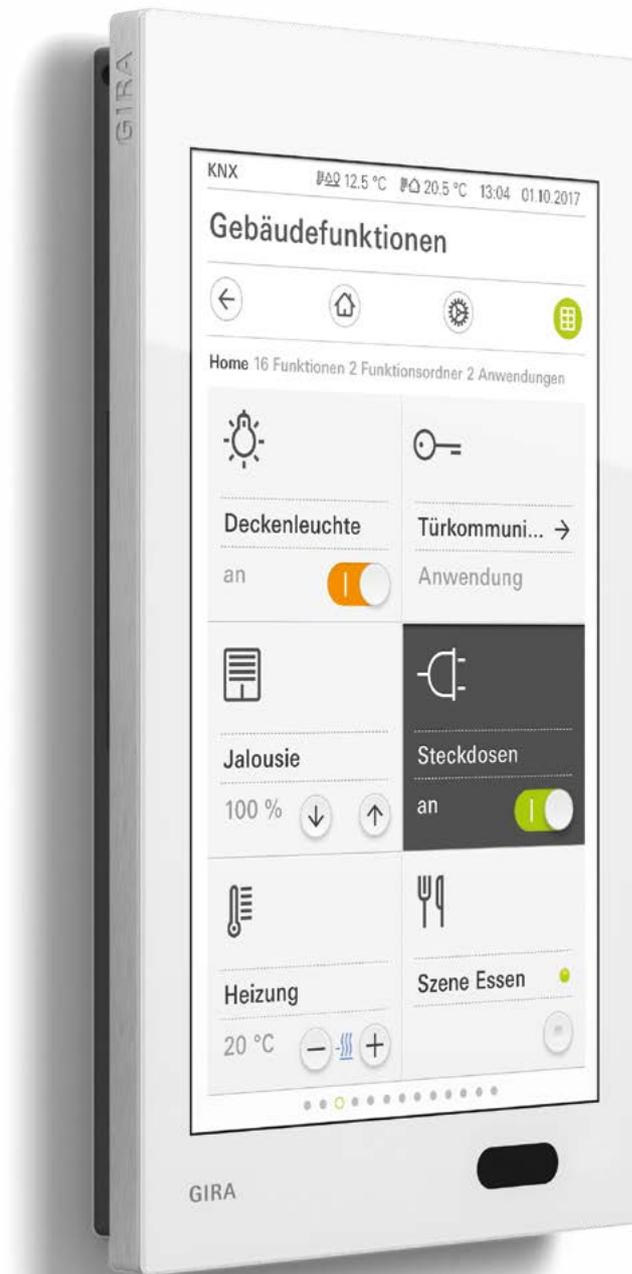
**Der Gira G1:** Von der Beleuchtung und Jalousiesteuerung über die Einstellung der Raumtemperatur, Online-Wetterprognose bis hin zur Türkommunikation – der neue Gira G1 ist das intelligente Bediengerät für die KNX Gebäudetechnik. Über das brillante Multitouch-Display lassen sich viele Funktionen komfortabel per Fingertipp oder mit Gesten wie Wischen und
