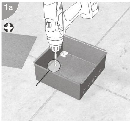
Das Blechgehäuse mit zwei Schrauben auf der Rohdecke befestigen.
